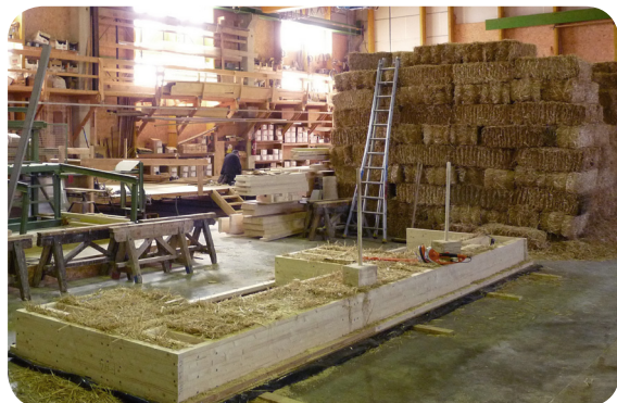
Caissons paille - Photo prise dans l'Atelier des charpentiers Mouysset frères. Copyright Bresson Schindlbeck Architectes
