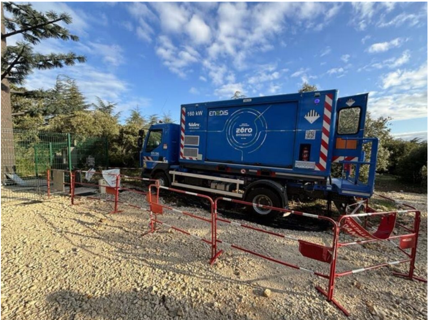
Le groupe électrogène zéro émission. ©Enedis
